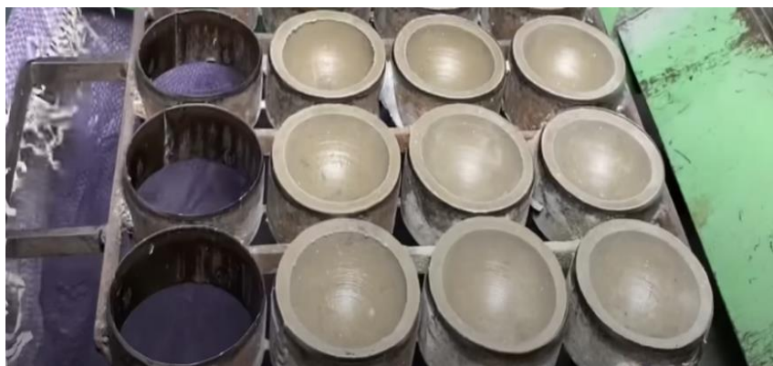
Rys.2. Połowa gumowego rdzenia piłki po procesie formowania.
