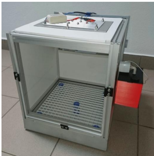
Rys. 4. Wstępny prototyp komory środowiskowej Fig. 4. Initial prototype of the environmental chamber
