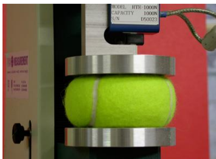
Rys.1. Piłka tenisowa w trakcie testów wytrzymałościowych [3]
