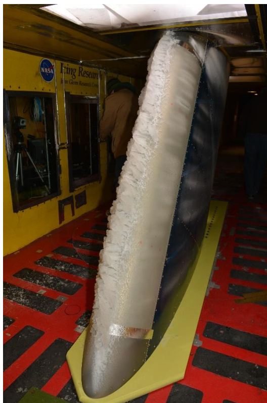
Rys. 1. Przykład warstwy lodu na modelu skośnego skrzydła, Ice Prediction Workshop 2 [3] Fig. 1. An example of ice cover for the swept wing model, Ice Prediction Workshop 2 [3]
