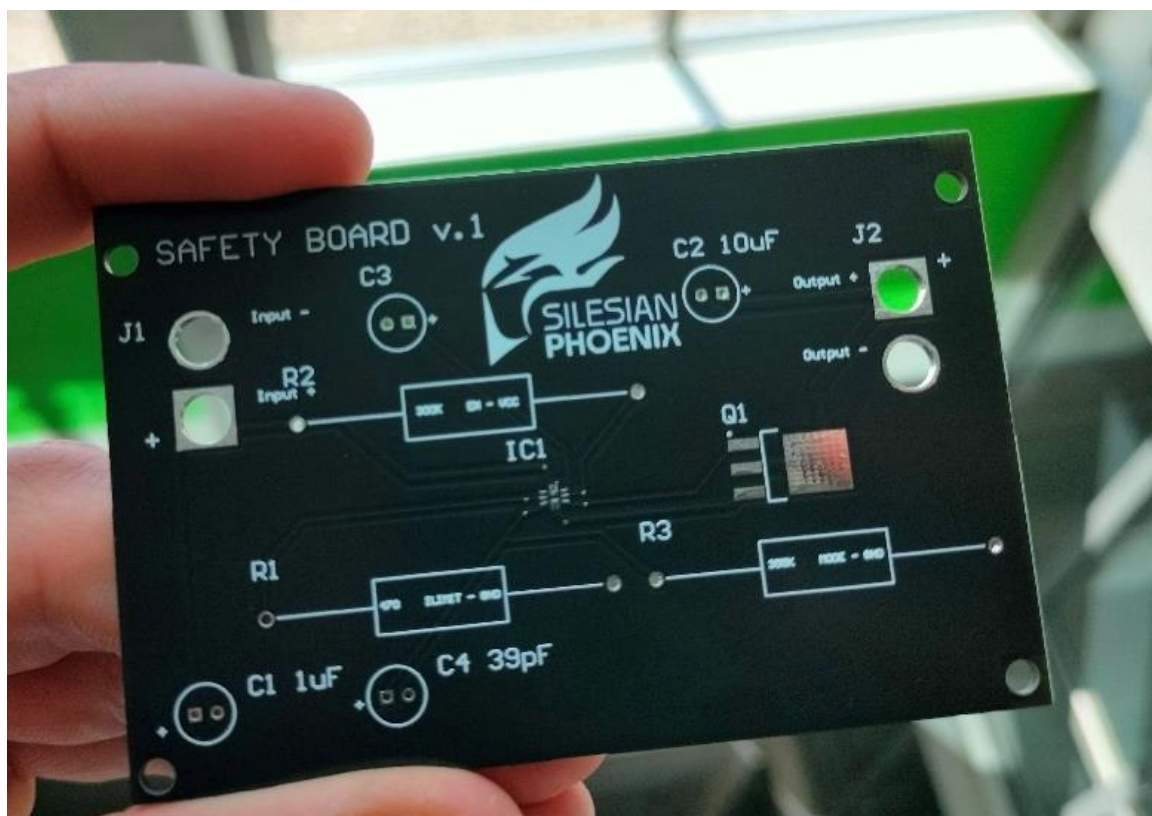
Rys. 3. Fizyczna płytki PCB modułu zabezpieczeń prądowych Fig. 3. Physical PCB protection board
