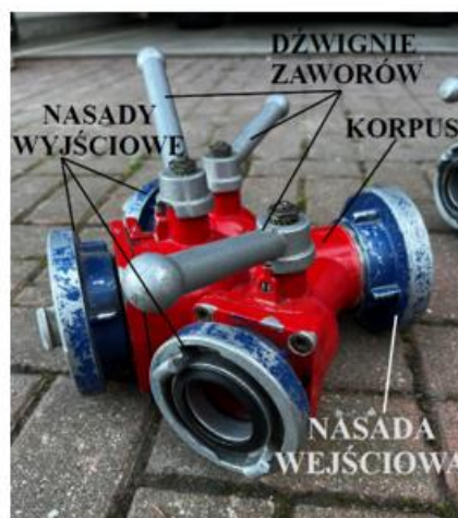
Rys. 2. Rozdzielacz kulowy – podstawowe elementy
