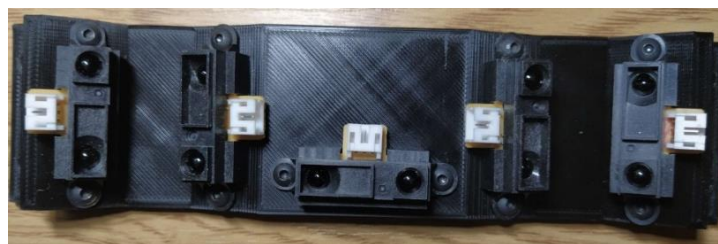
Rys. 3. Wydrukowany uchwyt z zamocowanymi czujnikami zbliżeniowymi Fig. 3. Printed handle with attached proximity sensors
