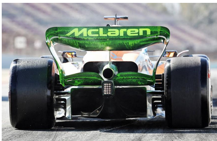
Rys. 4. Bolid Formuły 1 w trakcie badań przy użyciu FlowVis [1]
