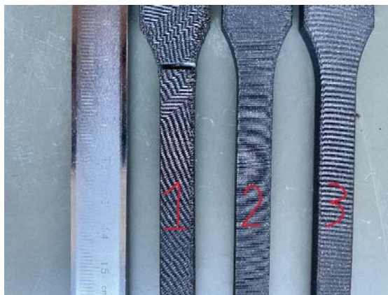
Rys. 1. Uzyskane próbki z materiału ASA, drukowane w pozycji pionowej w różnych warunkach
