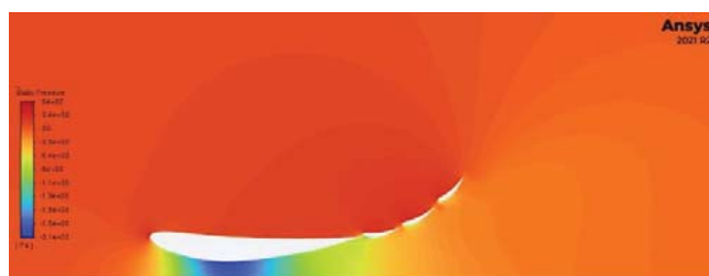
Rys. 7. Pole rozkładu ciśnień dla zewnętrznej części skrzydła Fig. 7. Pressure distribution for the external wing
