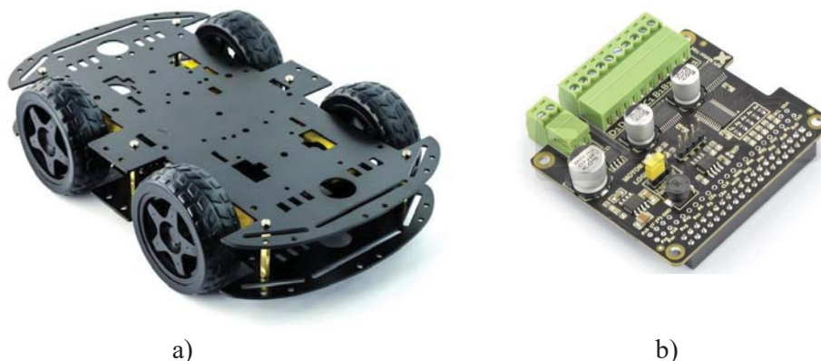
Rys. 1. a) Podwozie modelu samochodu RC z zamontowanymi silnikami prądu stałego, b) sterownik silników prądu stałego Motor Hat TB6612
