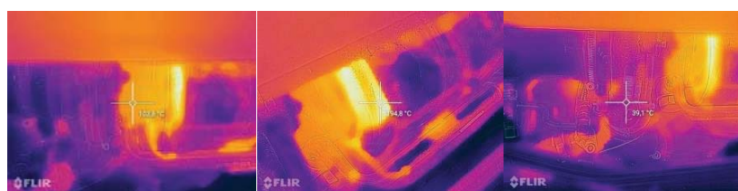
Rys.6. Wynik pomiaru temperatury na: korpusie, muszli wydechowej i muszli ssącej Fig.6. Results of temperature measurement by thermal imaging camera.
