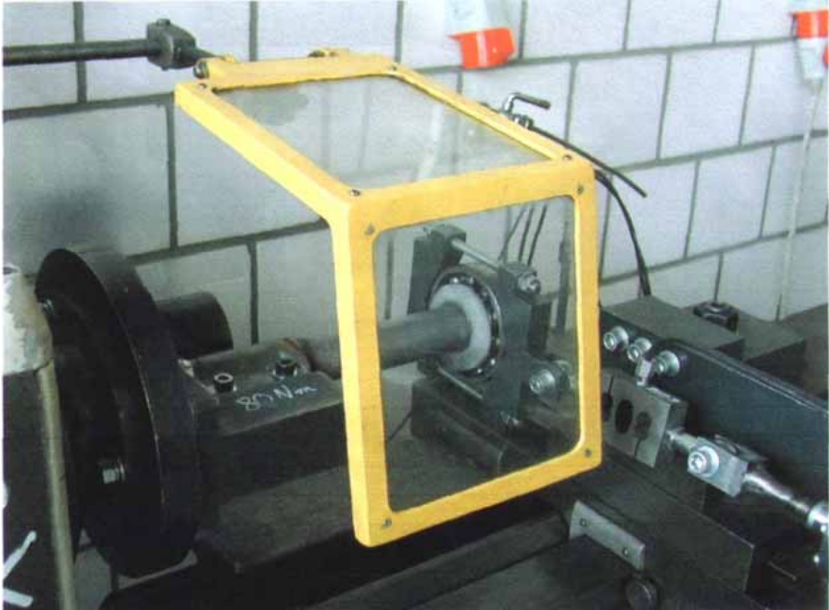
Rys. 7. Stanowisko do badań zmęczeniowych
