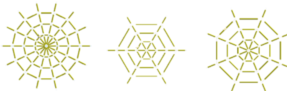
Rys. 1. Stworzone modele geometryczne sieci wraz z naniesioną siatką elementów skończonych
