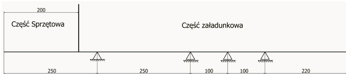
Rys. 1. Model belki do obliczeń reakcji Fig. 1. Beam model for calculation of reactions
