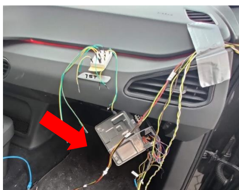
Rys. 3. Bramka diagnostyczna pojazdu VW ID.3 Fig. 3. Vehicle diagnostic gateway of the VW ID.3
