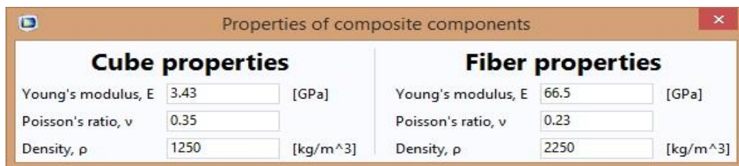
Rys. 2. Własności składników kompozytu Fig. 2. Properties of composite components
