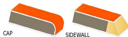
Rys. 2. Typy konstrukcji wewnętrznej snowboardów [4]
