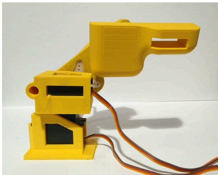
Rys. 1. Złożony robot wraz z serwami w obudowach Fig. 1. The complete robot with servos in housings
