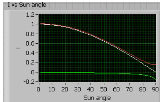
Rys. 1. Wykres zależności wartości natężenia prądu od kąta padania promieni słonecznych [2]
