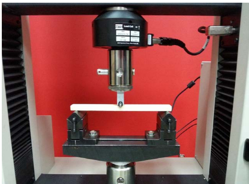
Rys. 1. Stanowisko do badania wytrzymałości na zginanie Fig. 1. Stand for testing flexural strength
