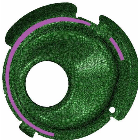
Rys. 2. Model MES siedziska sprężyny z naniesioną siatką elementów skończonych oraz zaznaczonymi obszarami do których przyłożono obciążenie pochodzące od sprężyny
