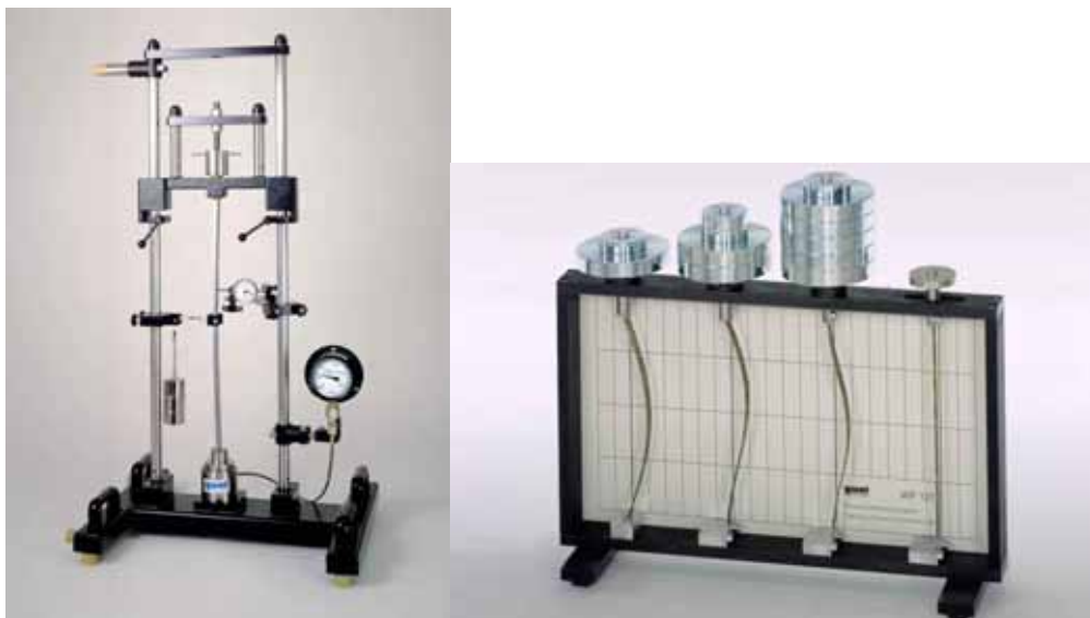
Rys. 3. Stanowiska do badania zjawiska wyboczenia firmy Gunt Hamburg [2]
