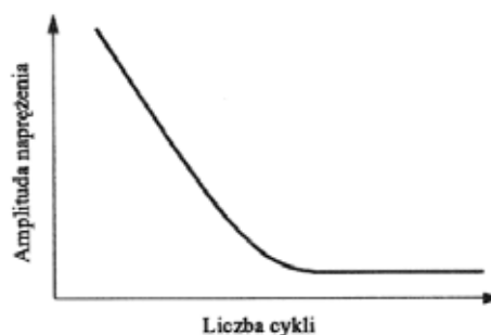
Rys.1. Typowy wykres S-N dla stali niskowęglowej [1]
