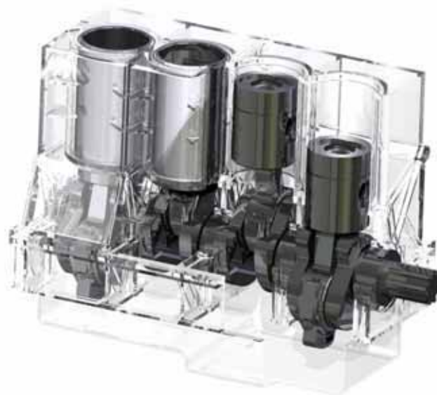
Rys. 1. Model 3D silnika złożonego ze wszystkich zamodelowanych elementów
