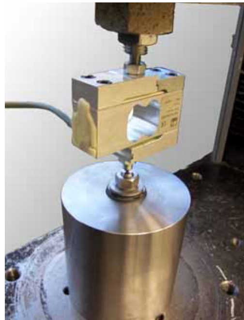
Rys. 4. Zamocowanie oprzyrządowania pomiarowego (głowica, przetwornik siły, zawór, masywna tuleja)
