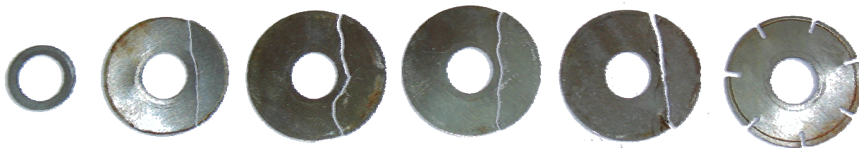
Rys. 6. Widok dysków zaworu (C1) amortyzatora po ukończonym teście „czasu życia”
