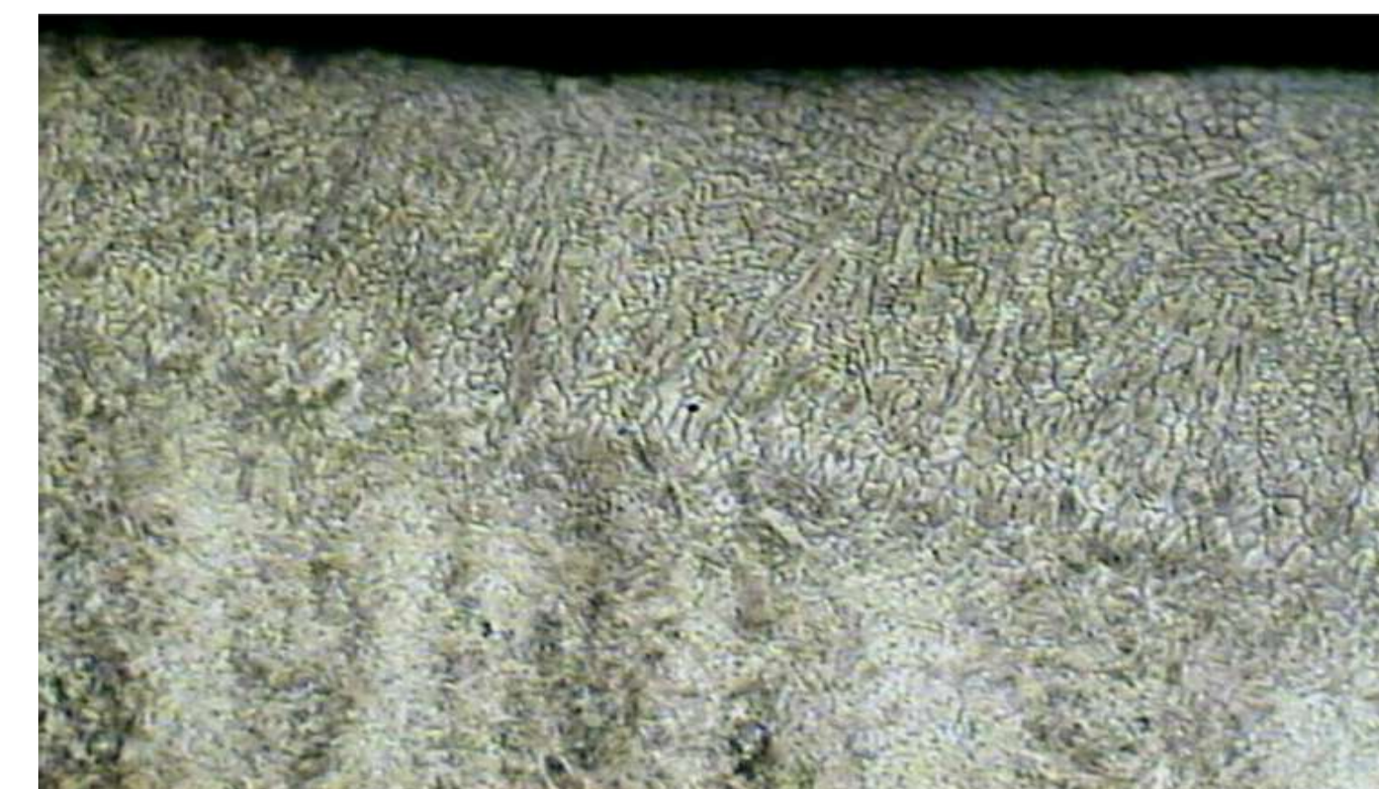
Brzeg przetopienia warstwy wierzchniej stali po stopowaniu proszkiem BN, moc lasera 2,0 kW
