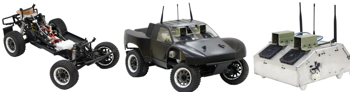
Rys. 2.2. Platforma AutoRally z widokiem od lewej - a) podwozia, b) złożonego pojazdu, c) jednostki obliczeniowej wraz z urządzeniami peryferyjnymi [60]
