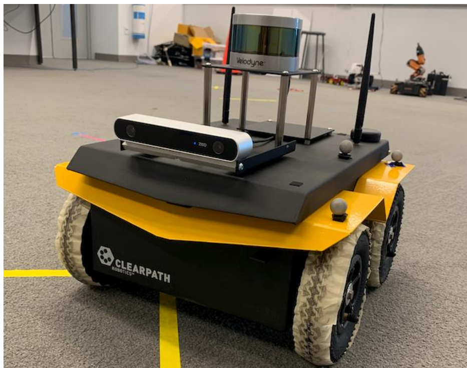
Rys. 2.5. Jackal UGV produkcji Clearpath Robotics z zabudowaną kamerą StereoLabs ZED [64]
