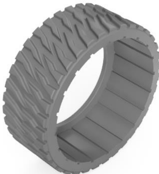
Rys. 4.4. Model opony z bieżnikiem przystosowanym do skał osadowych większej frakcji
