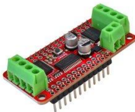
Rys. 6.4. Sterownik silników oparty o chipsety TB6612 oraz kontroler PCA9685 [74]
