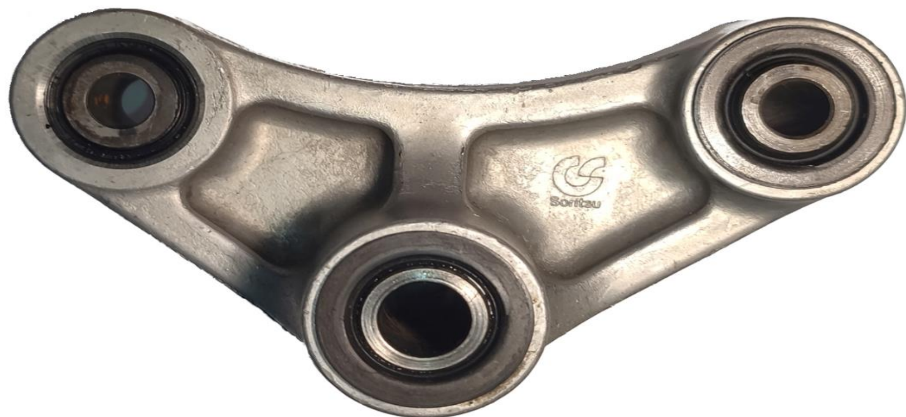
Rys. 1. Kołyska zawieszenia stosowana w motocyklach Kawasaki
