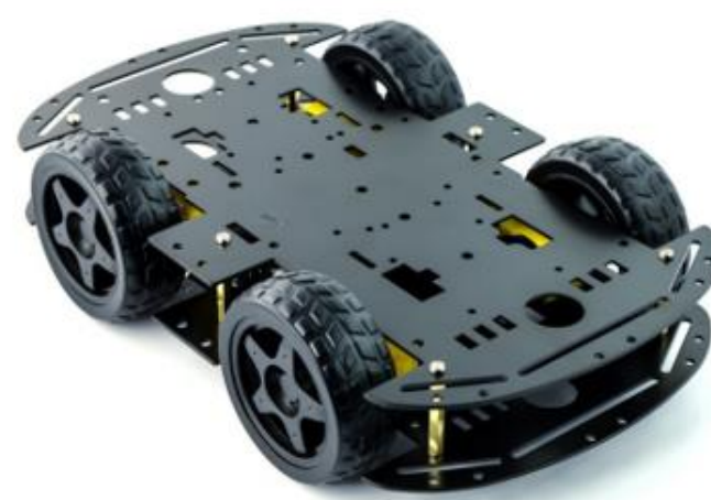
Rys. 7. Podwozie modelu zdalnie sterowanego samochodu z zamontowanymi silnikami prądu stałego [2]
