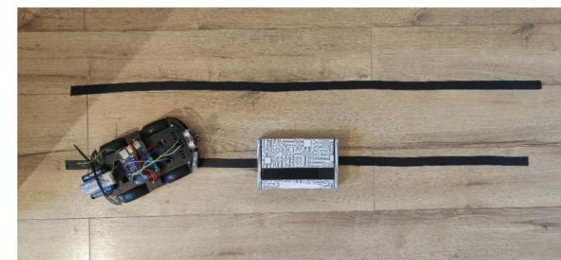
Rys. 25. Wektor testowy numer dwa, rozpoczęcie manewru wyprzedzania
