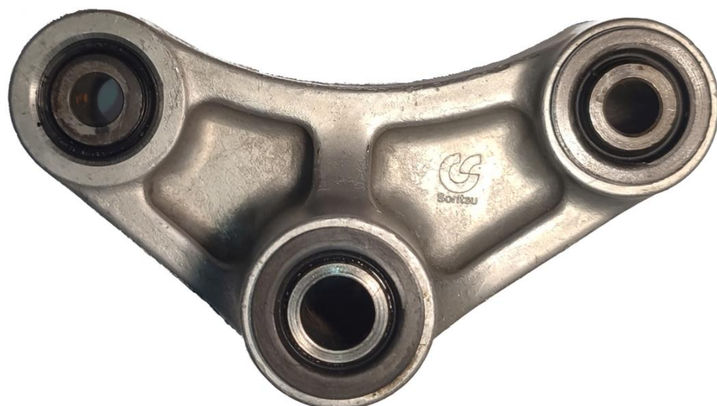
Rys. 1. Kołyska zawieszenia stosowana w motocyklach Kawasaki
