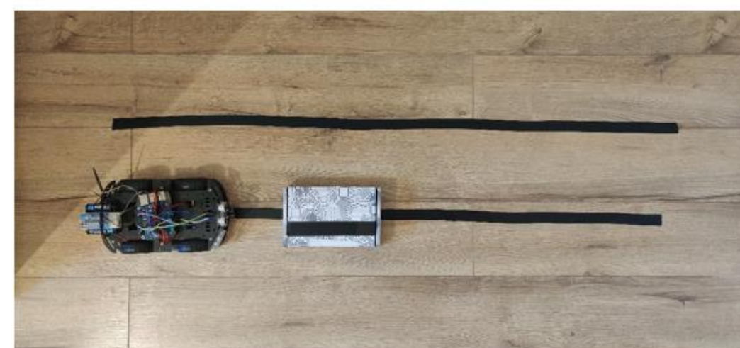
Rys. 24. Wektor testowy numer dwa, wykrycie pojazdu poruszającego się przed modelem zdalnie sterowanego samochodu
