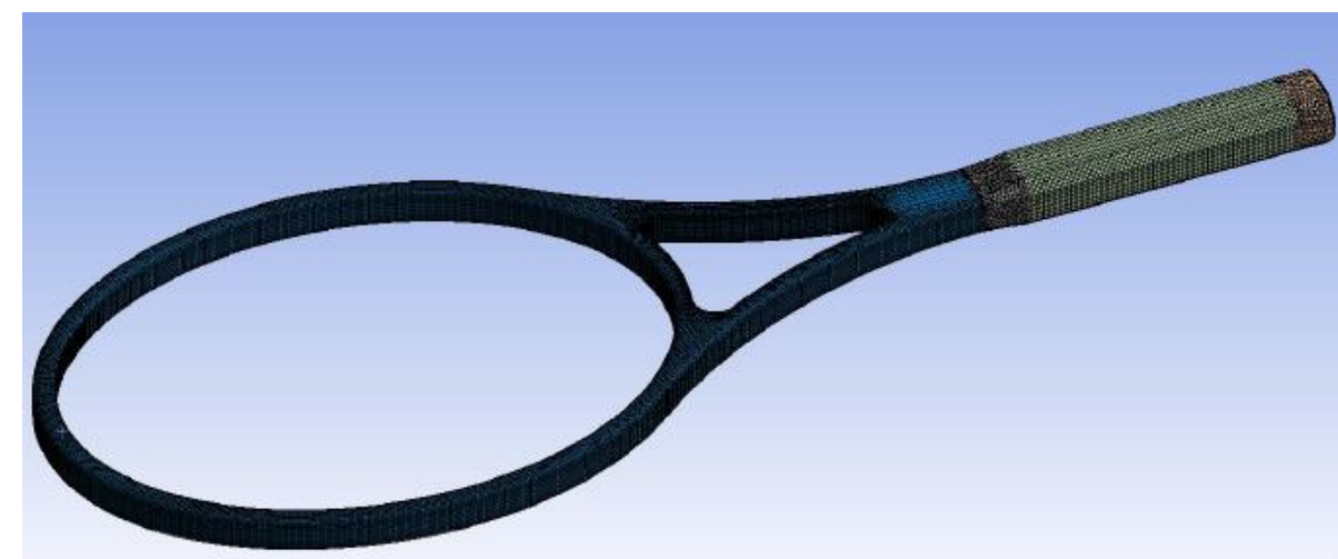
Rysunek 6.2 Siatka MES modelu numerycznego
