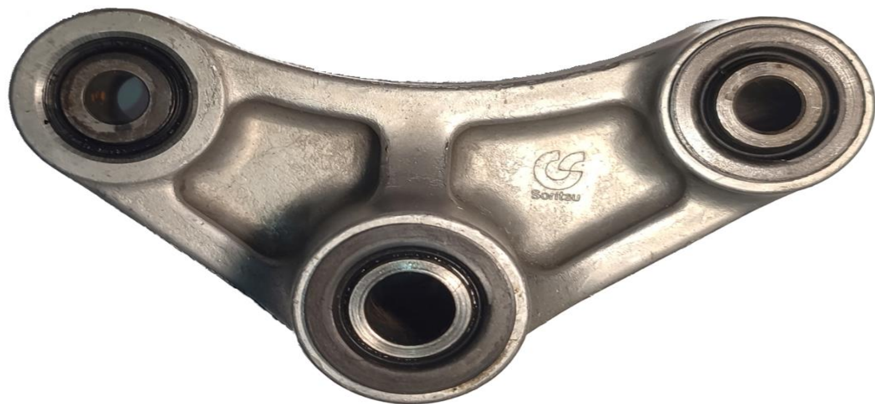
Rys. 1. Kołyska zawieszenia stosowana w motocyklach Kawasaki
