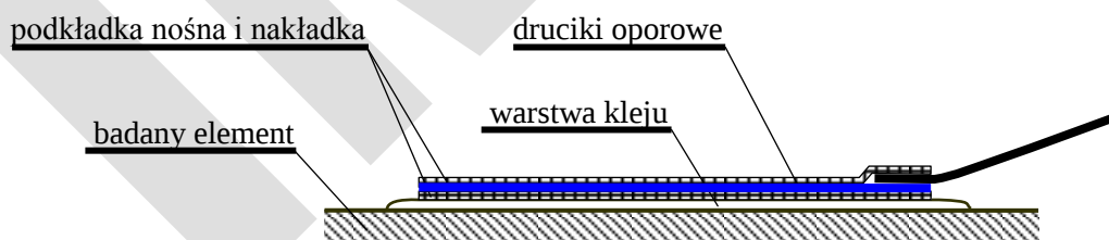
Rys. 3. Sposób naklejania czujnika tensometrycznego
