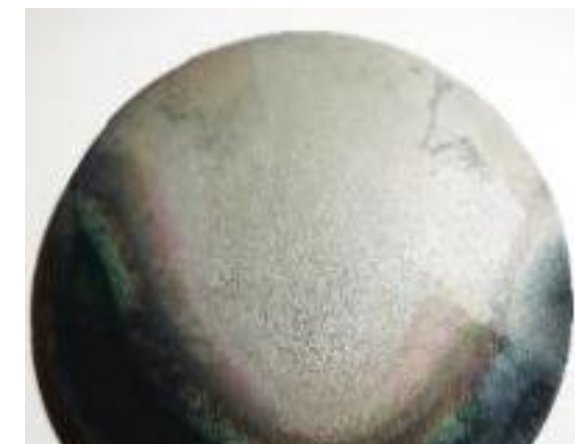
Powłoka NbSi na podłożu niobu po teście utleniania w wysokiej temperaturze
