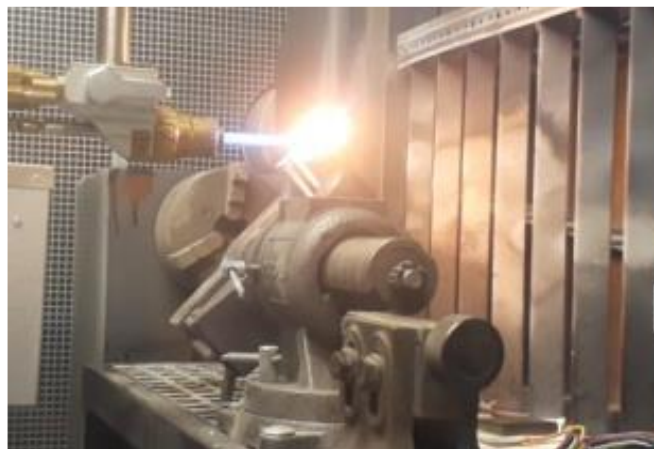
Badanie utleniania w wysokiej temperaturze powłoki NbSi
