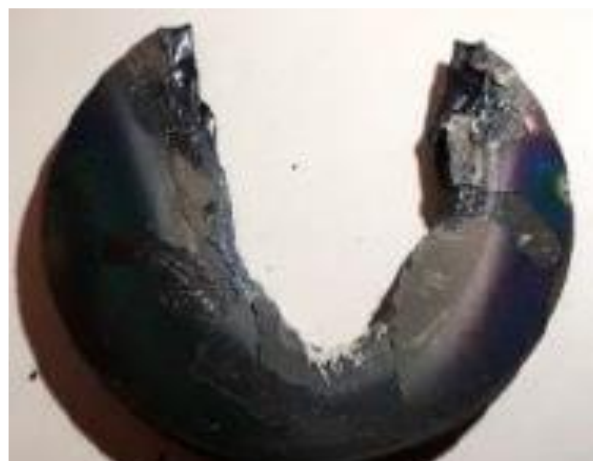
Podłoże niobu niepokrytego po teście termicznym
