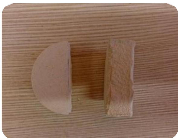
Rys. 1. Porowaty szkielet ceramiczny wytworzony na bazie popiołu lotnego
