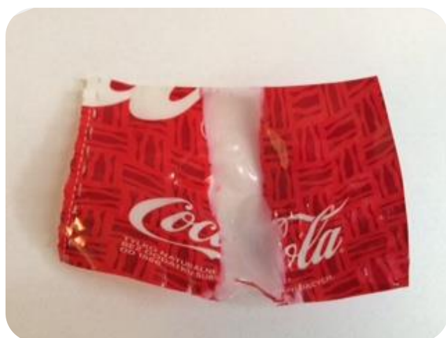
Rys. 1. Fragment odpadowej folii opakowaniowej z napoju Coca-Cola, z widocznym obszarem usunięcia powłoki lakierniczej
