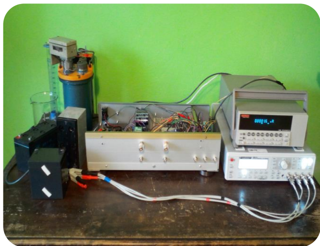
Rys. 1 Stanowisko badawcze do pomiarów impedancyjnych ogniw elektrochemicznych
