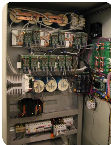
Rys. 1. Przykładowy pięciopoziomowy przekształtnik hybrydowy 15 kW / 1 kV
