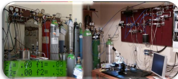
Rys. 1. System dozowania mieszanin gazowych do testowania chemicznych czujników gazów
