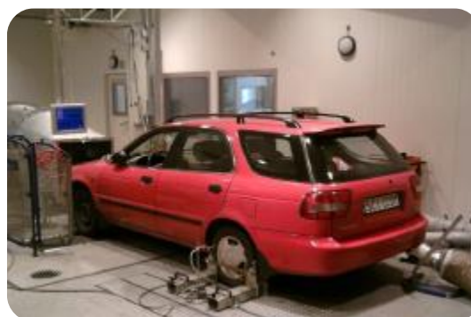
Rys. 2. Badania komponentów systemu Smart Hybrid na hamowni podwoziowej
