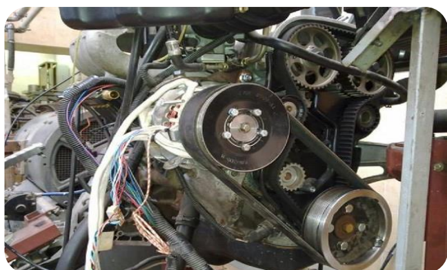
Rys. 1. Maszyna elektryczna wspomagająca silnik spalinowy zainstalowana na stanowisku laboratoryjnym
