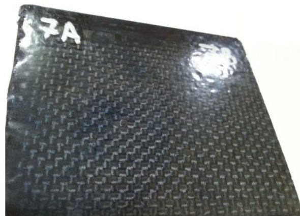
Rys. 2. Opracowany kompozyt do ochrony przed promieniowaniem elektromagnetycznym.
