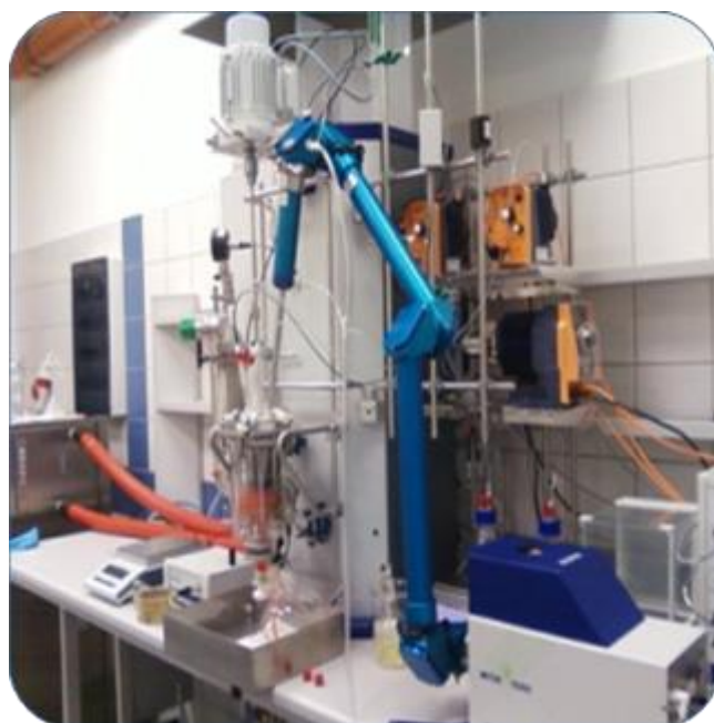
Rys. 1. Automatyczny reaktor z modulem analitycznym FTIR
