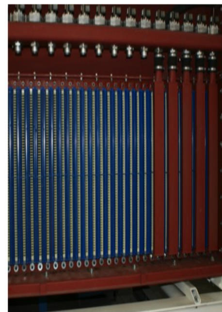
Rys. 12. Pakietowa konstrukcja suchego odpylacza kompaktowego [4].
