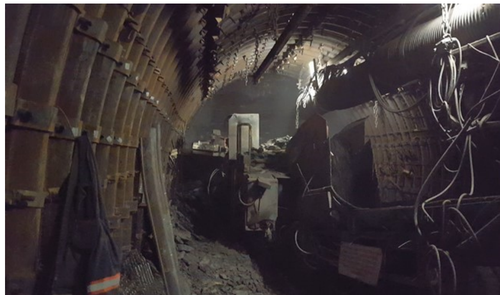
Rys. 1. Działanie suchego odpylacza powietrza HBKO firmy CFT w czasie drażnienia wyrobiska [4].
