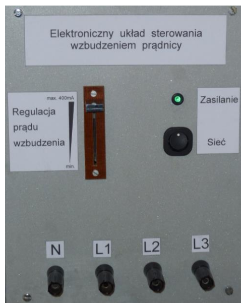
Rys. 3.4. Widok płyty czołowej układu sterowania wzbudzeniem prądnicy
