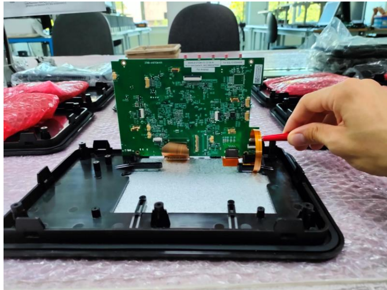
Rys. 8. Składanie dotykowego panelu sterującego
