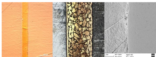
Rys. 4. Zdjęcia zgrzewanych próbek 304L; 316L i 316Ti z przekładkami CuZn37 i CuNi12Zn24 o grubości 0,1 mm
