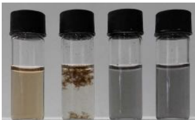
RYSUNEK 1 Stabilność dyspersji EEO i EO w obecności \text{Ca}(\text{OH})_2 (od lewej: wodna dyspersja EO, wodna dyspersja EO po dodaniu nasyconego roztworu \text{Ca}(\text{OH})_2 , wodna dyspersja EEO, wodna dyspersja EEO po dodaniu nasyconego roztworu \text{Ca}(\text{OH})_2 ) [18].
