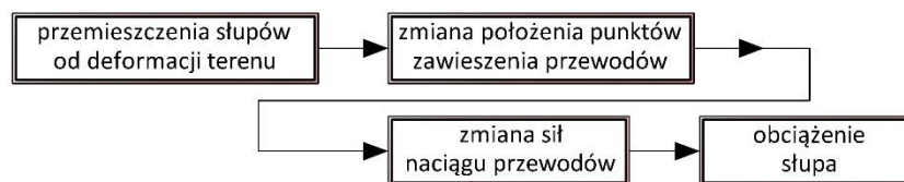
Rys. 6. Uproszczona relacja pomiędzy wymuszonymi przemieszczeniami słupa i oddziaływaniami przewodów
