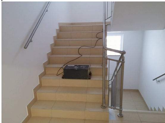
Fot. 3. Pomiar terenowe izolacyjności od dźwięków uderzeniowych.
