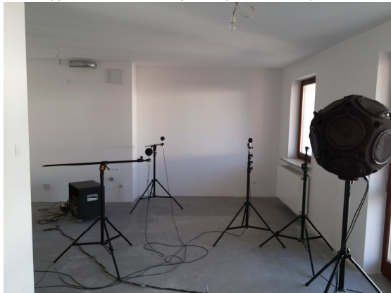
Fot. 2. Pomiar terenowe izolacyjności od dźwięków powietrznych między pomieszczeniami.
