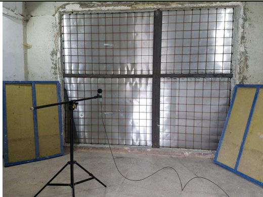
Fot. 1. Pomiar laboratoryjny izolacyjności akustycznej elementów budowlanych. Pomiar izolacyjności od dźwięków powietrznych.
