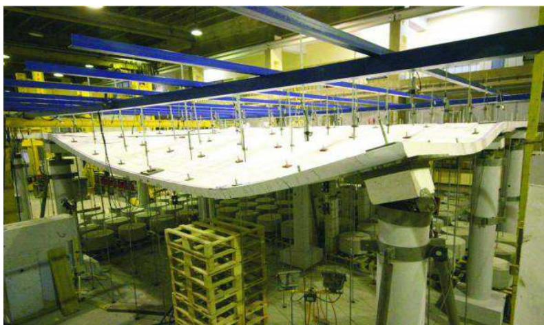
Badania ustroju płytowo-słupowego
