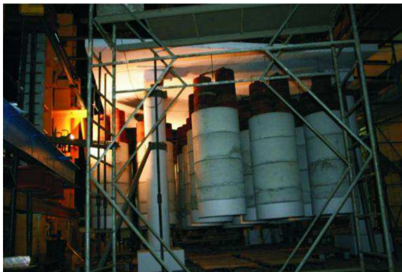
Obciążniki grawitacyjne w trakcie badań
