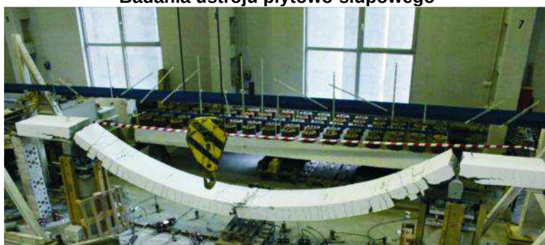
Badania taśmy żelbetowej
