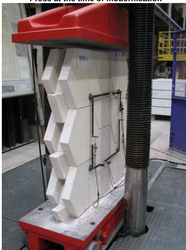
Badania na ściskanie ścian murowanych Axial compression of masonry specimen
