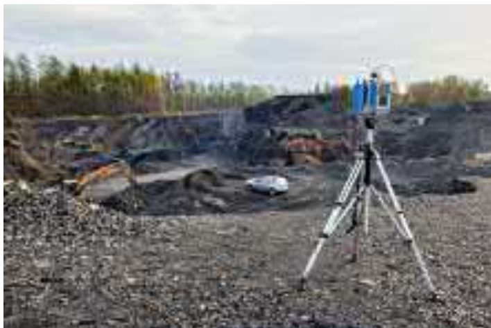
Stanowisko pomiarowe z wykorzystaniem zintegrowanego systemu TLS i IRT
