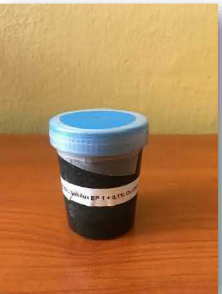
Mobil Mobilux EP1 + 0,1% Cu CNT
