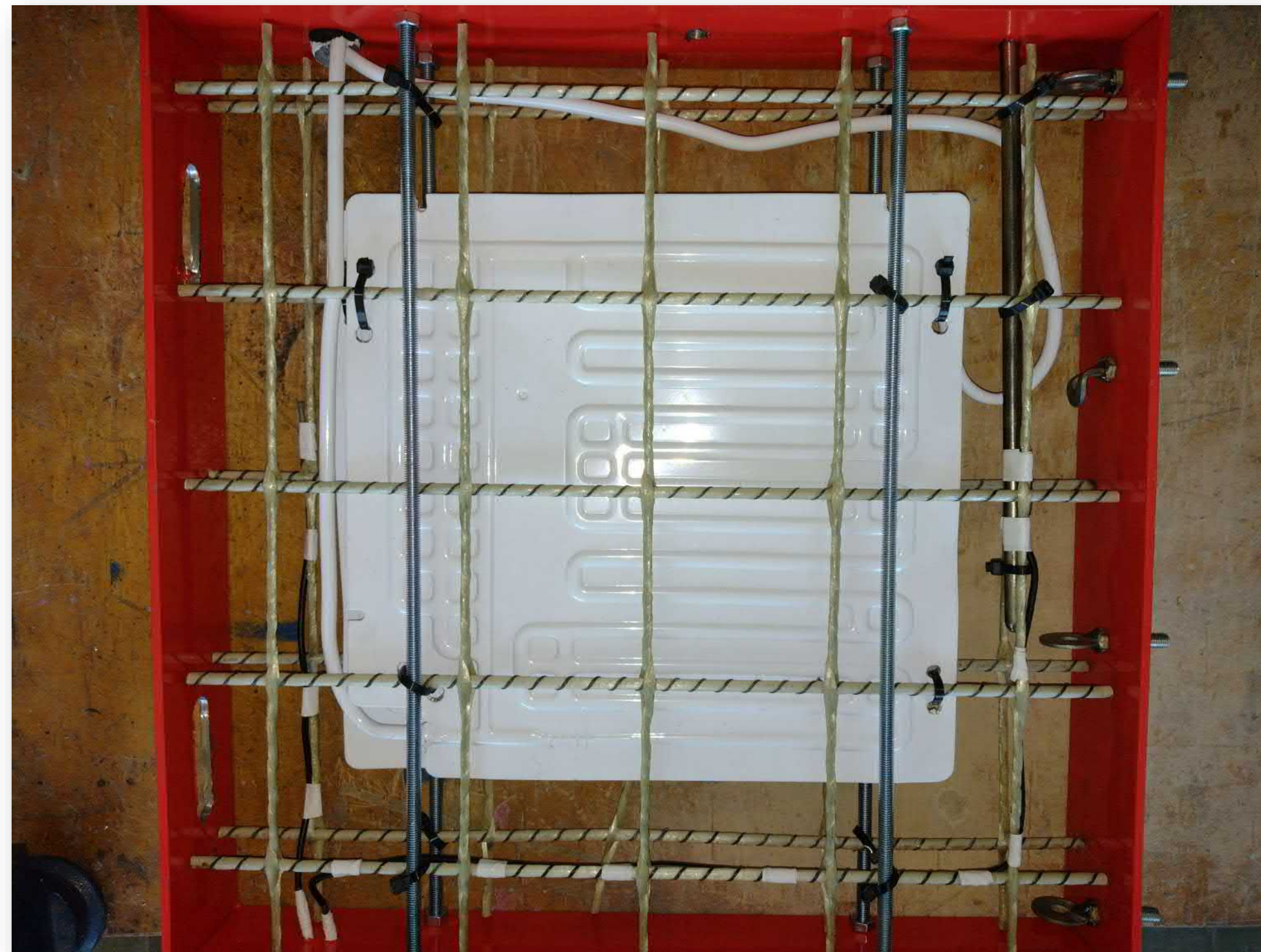
forma do bloczków betonowych wraz z systemem chłodzenia
