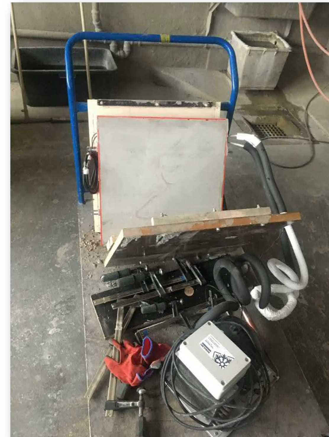
betonowy bloczek wraz z systemem chłodzenia
