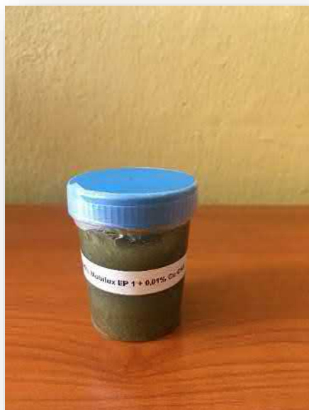
Mobil Mobilux EP1 + 0,01% Cu CNT
