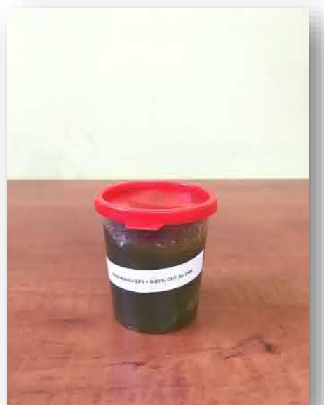
Mobil Mobilux EP1 + 0,01% CNT Au 2AM
