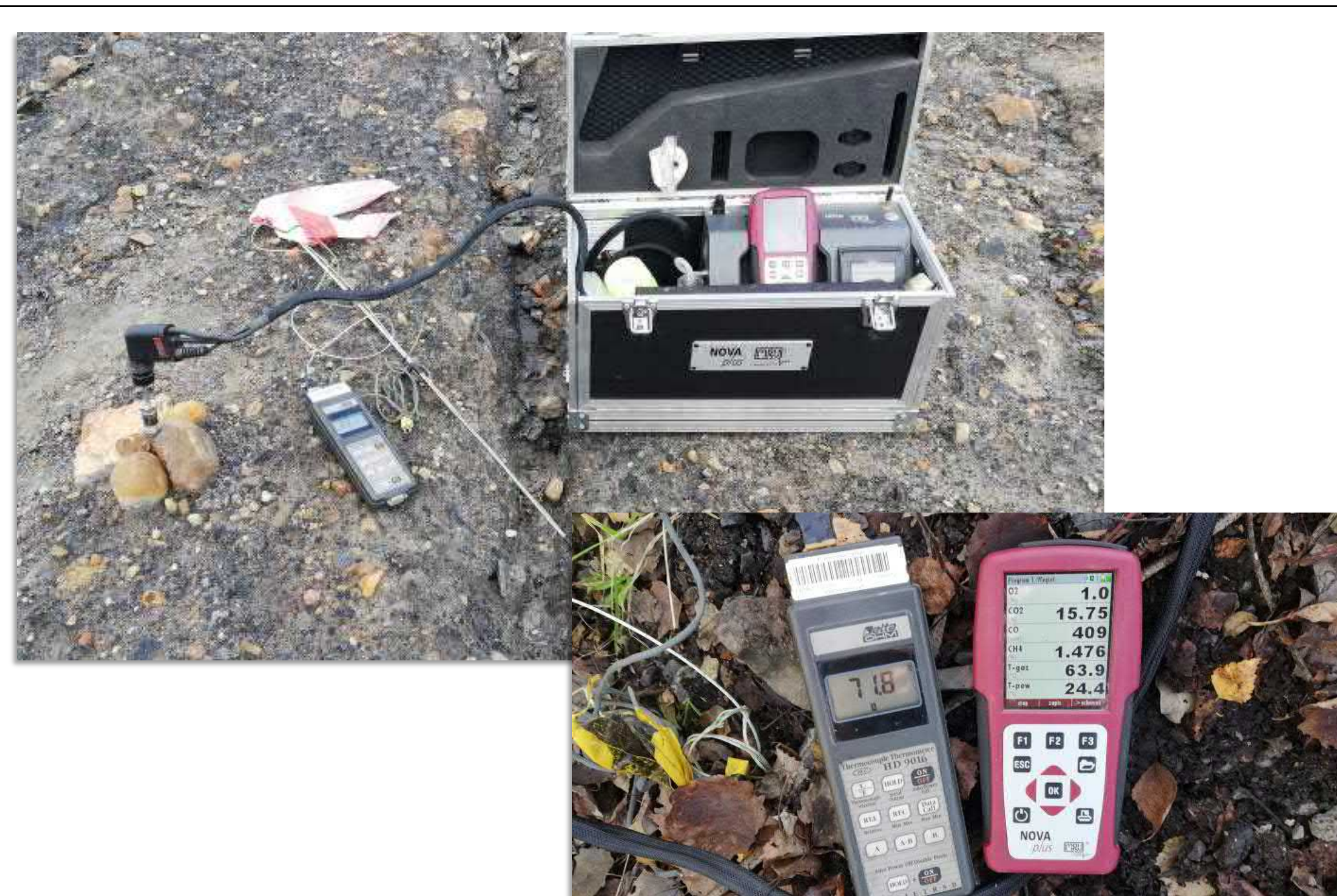
Pomiary temperatury i stężeń gazów we wnętrzu zwałowisk
