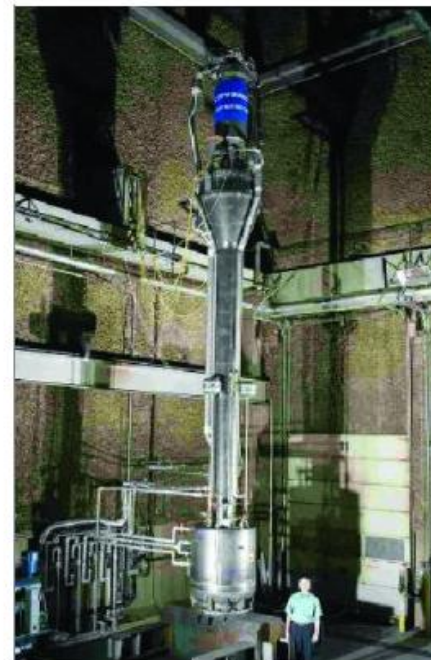
Urządzenie termoakustyczne do skraplania gazu ziemnego Niebieski element to palnik gazowy, poniżej termoakustyczny generator, element najniższy to skraplarka.
