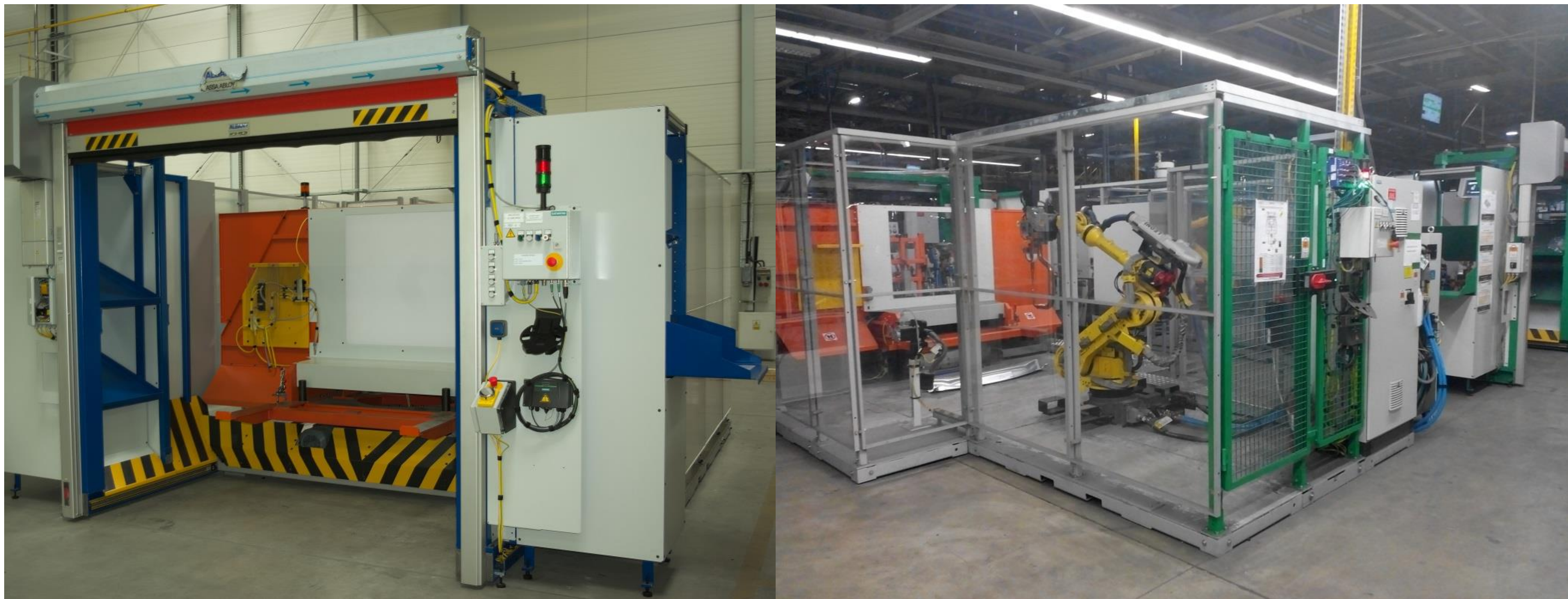
Rzeczywiste gniazdo do łączenia podzespołów karoserii samochodowych, zainstalowane w fabryce GM Opel w Gliwicach
