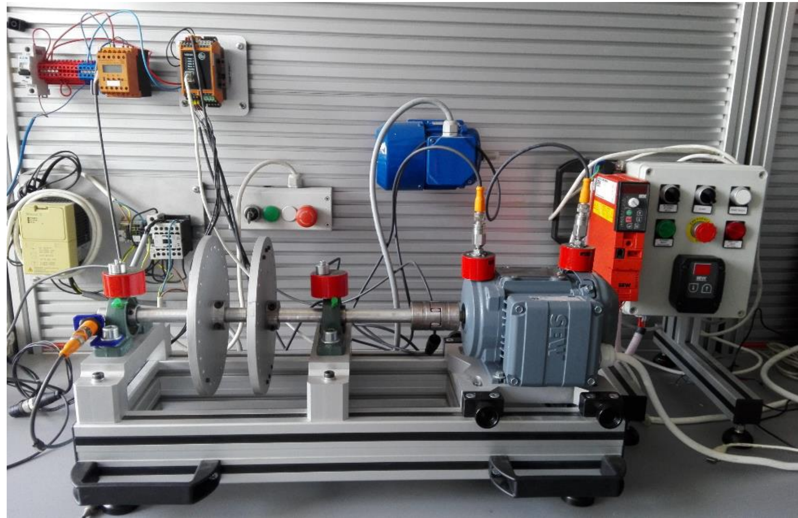
Rys. Widok stanowiska do badania stanu eksploatacyjnego maszyn wirujących
