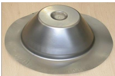
Rys. 1. Wytłoczka przemysłowa - pokrywa sprężarki silnika lotniczego – stożek, wykonana z blachy o grubości 0,45 mm ze stopu Inconel 625.
