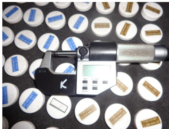
Rys. 3. Komplet wymiarowy podkładek regulacyjnych Fig. 3. The injector regulation pad packages
