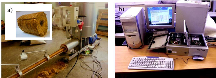
Rys. 6. Maszyna do ciągłej aglomeracji w technice formowania ślimakowego: a) maszyna w sprzężeniu z zestawem aparatury pomiarowej, b) zestaw pomiarowo-badawczy i rejestracji danych
