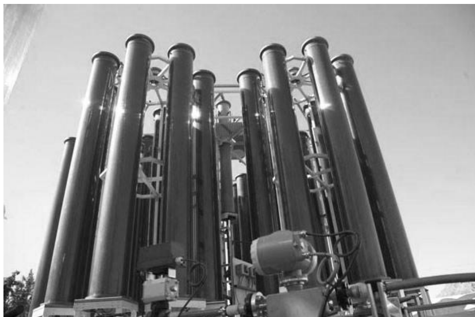
Rys. 1. Instalacja pilotażowa produkcji biopaliwa z glonów (bioreaktory pionowe) wybudowana w Alicante (Hiszpania) ( http://biofuelstp.eu/algae-aquatic-biomass.html )
