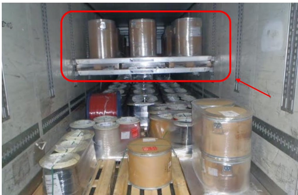
Rysunek 7. Załadunek naczepy wykorzystujący system double-deck. Źródło: opracowanie własne.
