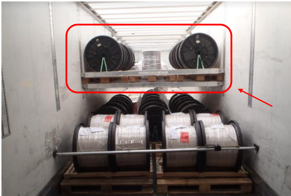
Rysunek 6. Załadunek naczepy z wykorzystaniem systemu double-deck. Źródło: opracowanie własne.
