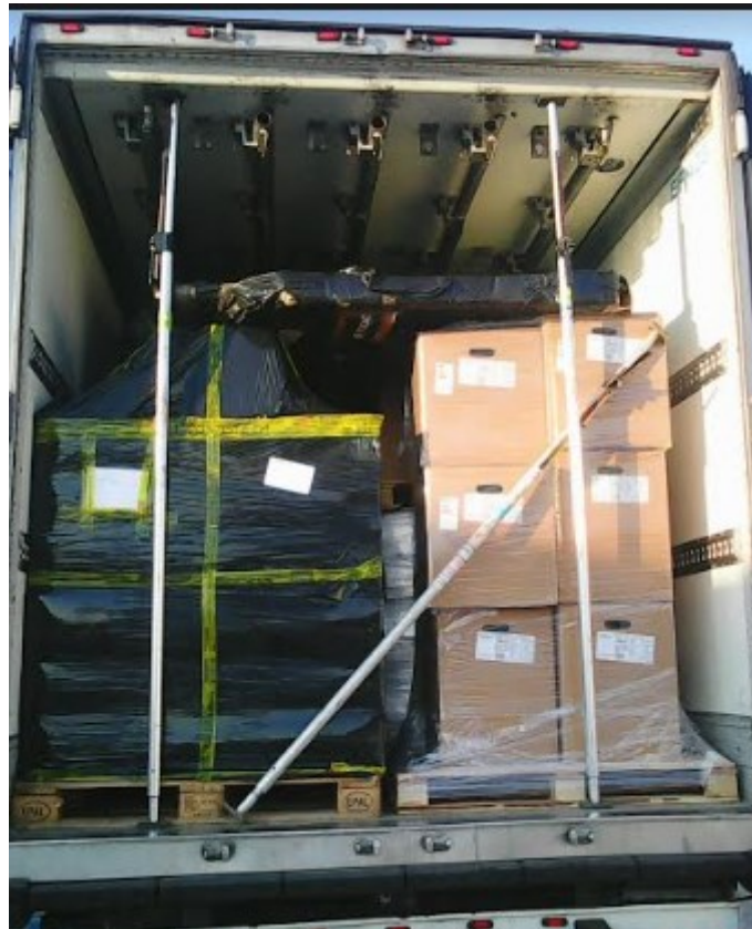
Rysunek 4. Przykład wykorzystania przestrzeni ładunkowej dla palet oraz paczek. Źródło: opracowanie własne.
