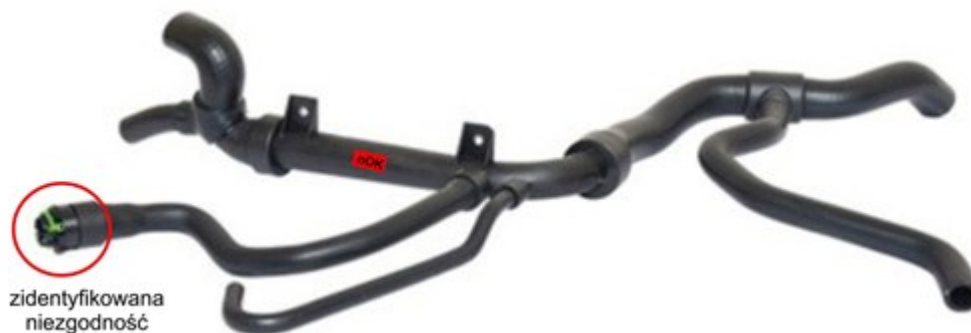
Rys. 1. Produkt podlegający kontroli – wąż gumowy chłodnicy wody z przewodami układu chłodzenia z wykrytą niezgodnością. Wyrób oznaczony jako nOK. Źródło: Opracowanie własne.
