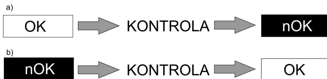
Rys. 3. Rodzaje błędów kontrolera: a) błąd I rodzaju – wyrób OK, natomiast decyzja nOK; b) błąd II rodzaju – wyrób nOK, natomiast decyzja OK
