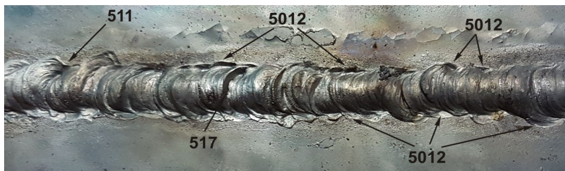
Rys. 2. Wykryte niezgodności podczas badania wizualnego złącza spawanego od strony lica spoiny: 5012 – podtopienie przerywane, 511 – niewypełnienie rowka spawalniczego, 517 – złe ponowne rozpoczęcie spawania
