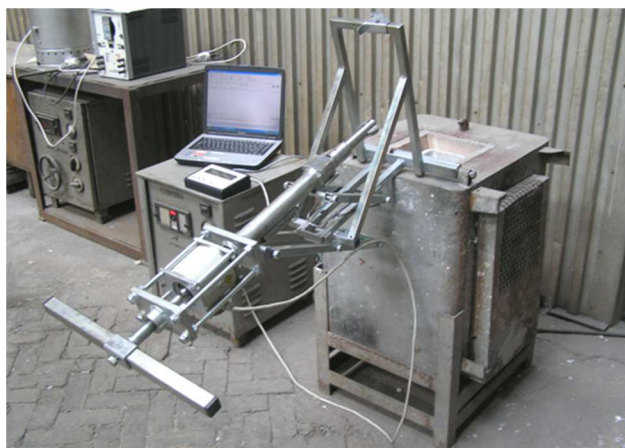
Stanowisko ustawione w pozycji umożliwiającej wygodne mocowanie próbki
