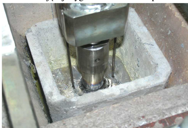
Wprowadzenie obciążenia wstępnego, zanurzenie próbki w kąpeli metalizującej i zadanie obciążenia właściwego
