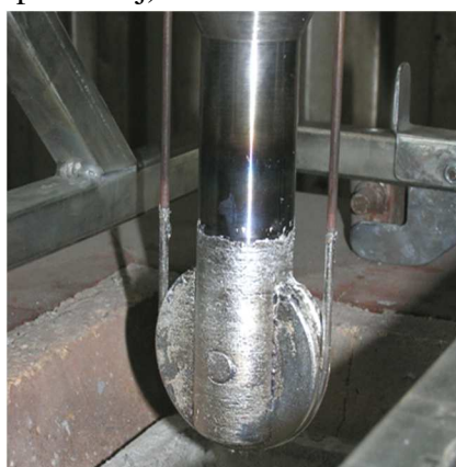
Próbka po wynurzeniu z kąpeli metalizującej
