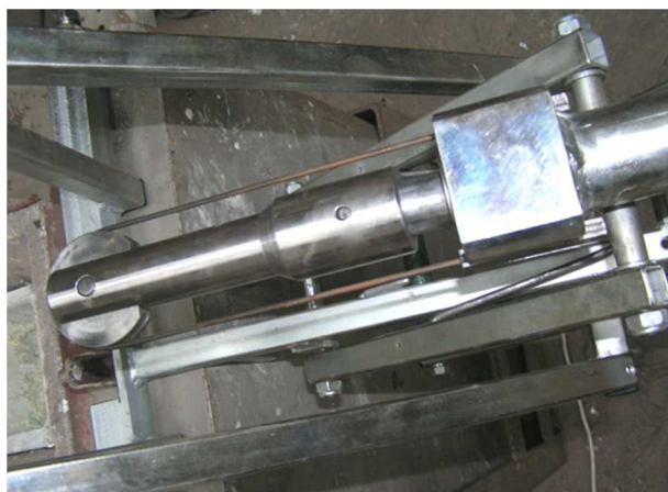
Założenie próbki (stanowisko w pozycji poziomej)
