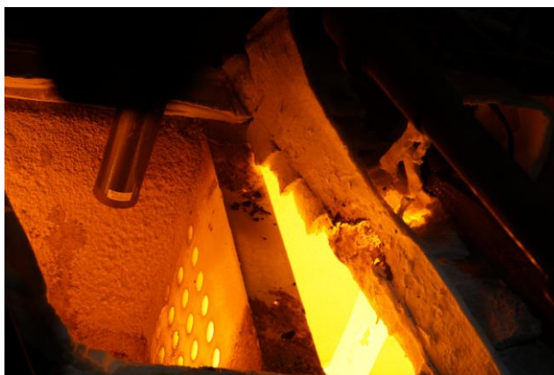
Rys 2. Wygrzana kadź pośrednia z zabudowanym filtrem ceramicznym.
