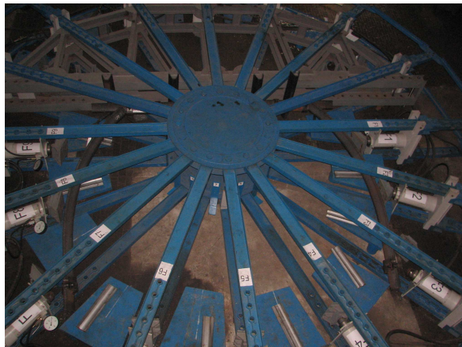
Stanowisko badań wytrzymałości konstrukcji (podporności) odrzwi obudowy wyrobisk korytarzowych i komorowych
