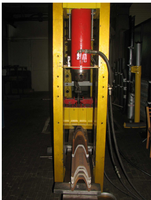
Prasa hydrauliczna do badań elementów obudów górniczych
